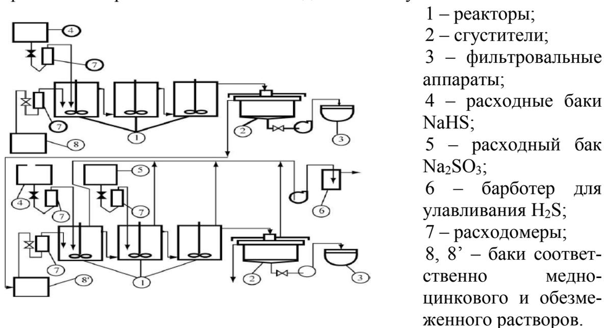
Рис. 28. Схема цепи аппаратов для селективного извлечения из растворов сульфидов меди и цинка гидросульфидом натрия
