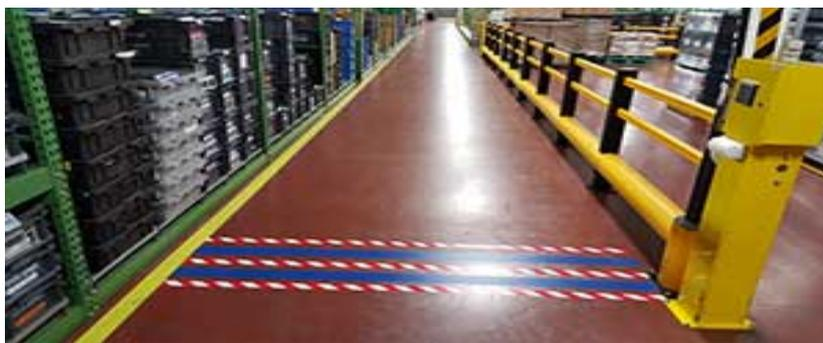
Рис. 4. Повышение безопасности с помощью напольной ленты
