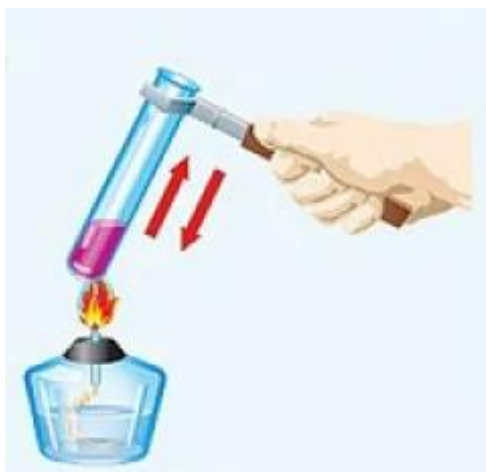
Рис. 12. Нагревание пробирки на открытом пламени
