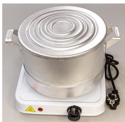
Рис. 10. Бани: водяная (а) и песчаная (б)
