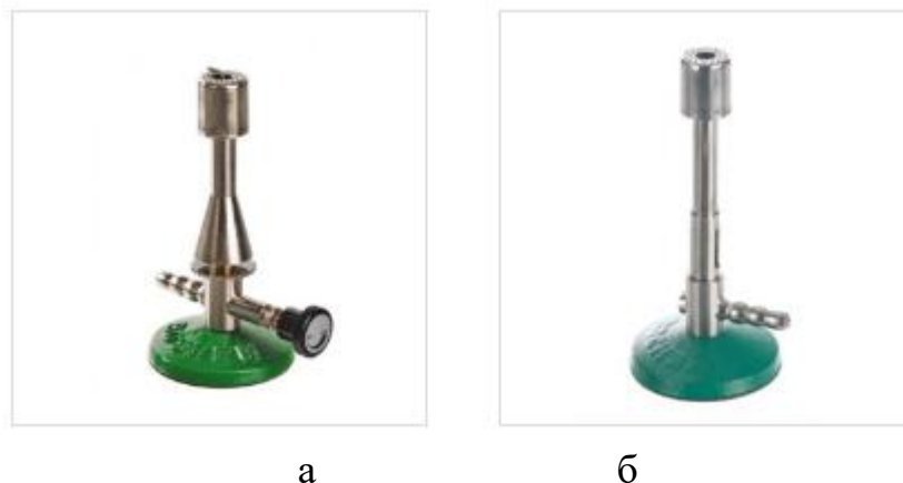
Рис. 7. Горелки: Теклю (а) и Бунзена (б)
