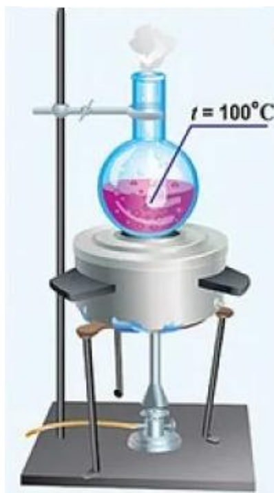
Рис. 13. Нагревание круглодонной колбы на водяной бане
