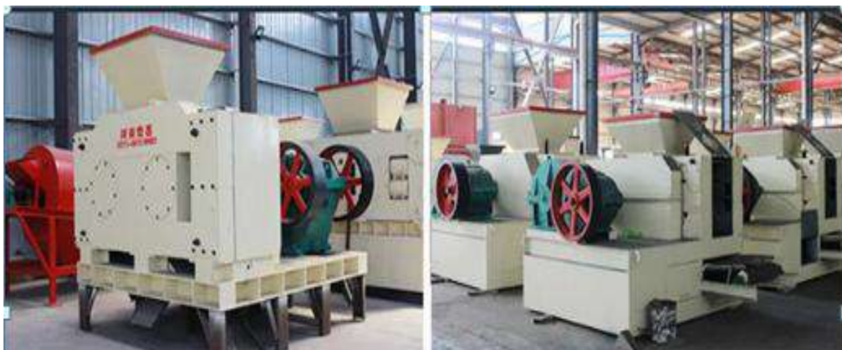
Рис. 26. Современные вальцовые прессы для производства брикетов
