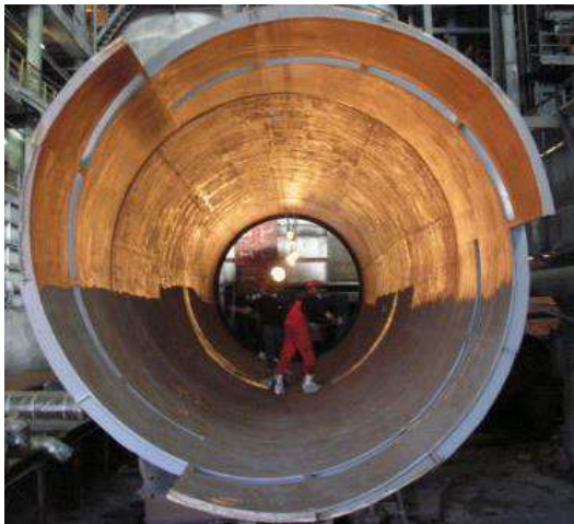
Рис. 20. Внутренняя поверхность барабанного окомкователя, футерованного резиной
