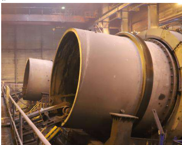
Рис. 19. Барабанный окомкователь: а – подача шихты конвейером; б – разгрузка сырых окатышей на грохот
