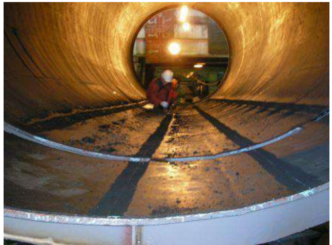
Рис. 20. Внутренняя поверхность барабанного окомкователя, футерованного резиной
