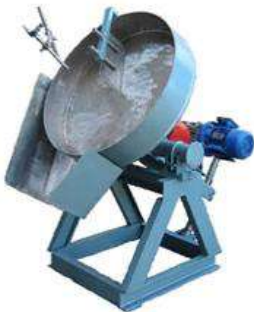
Рис. 21. Тарельчатый окомкователь: а – общий вид; б – схема устройства, 1 – чаша; 2 – установка скребков; 3 – привод чаши; 4 – механизм регулирования угла наклона; 5 – опора; 6 – копир; 7 – конечный выключатель
