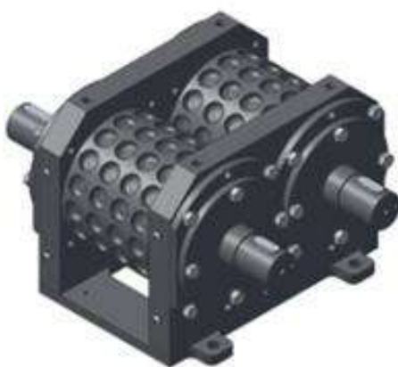
Рис. 27. Вальцовый пресс: а – общий вид, б – прессующие вальцы
