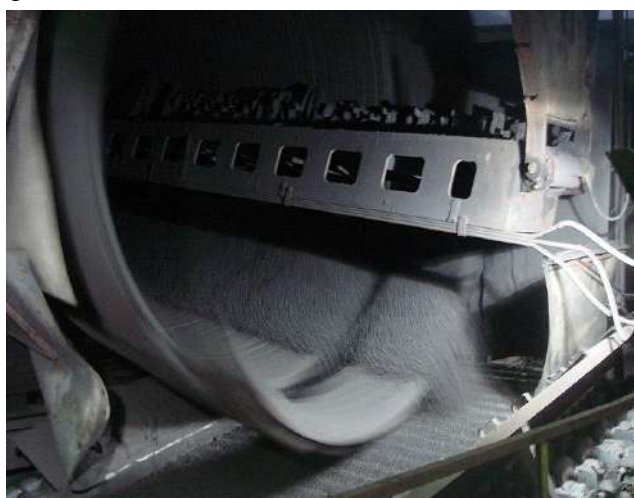
Рис. 19. Барабанный окомкователь: а – подача шихты конвейером; б – разгрузка сырых окатышей на грохот
