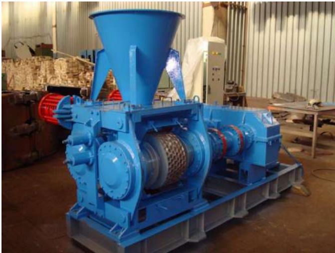
Рис. 29. Вальцовый пресс с коническим шнеком-подпрессовщиком
