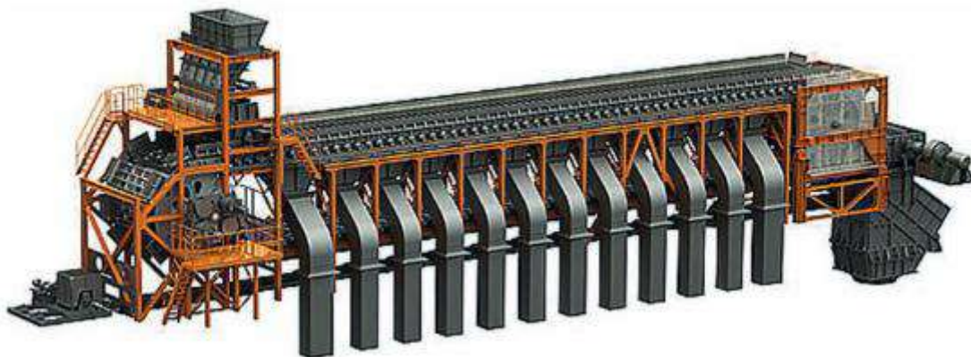
Рис. 2. Современная агломерационная (спекательная) машина ленточного типа
