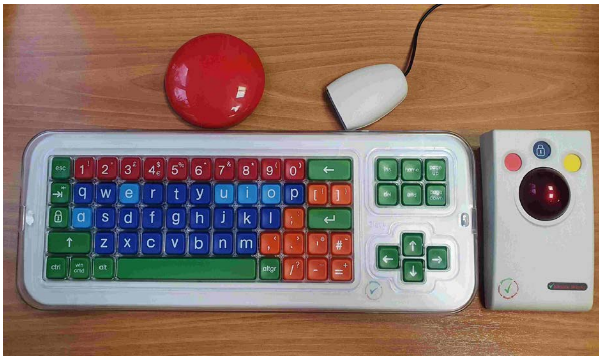
Рисунок 6 - Специальная клавиатура для людей с нарушением опорно-двигательного аппарата
