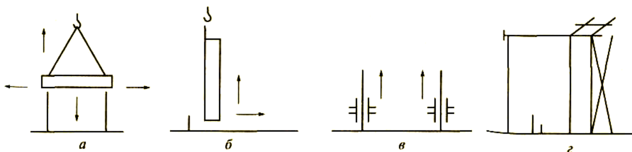
Рис.3.12. Монтажные методы в зависимости от способа установки элементов в проектное положение: а) свободный; б) ограниченно свободный; в) принудительный; г) безвыверочный
