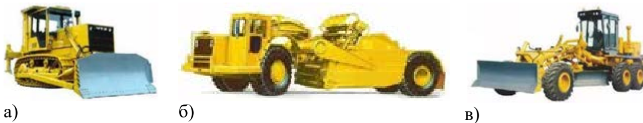
Рис. 1.1. Землеройно-транспортные машины а) бульдозер; б) скрепер; в) грейдер
