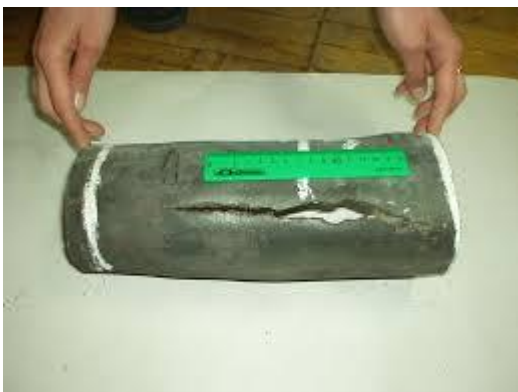
Рисунок 2. Свищ в трубе
