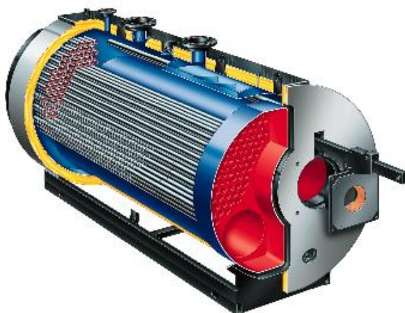
Рисунок 10.15 - Разрез низкотемпературного трехходового водогрейного котла для жидкого и газообразного топлива марки Vitomax 300
