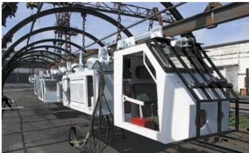
Рис. 1.13. Дизель-гидравлический локомотив ДПЛ-80 на подвесной монорельсовой дороге
