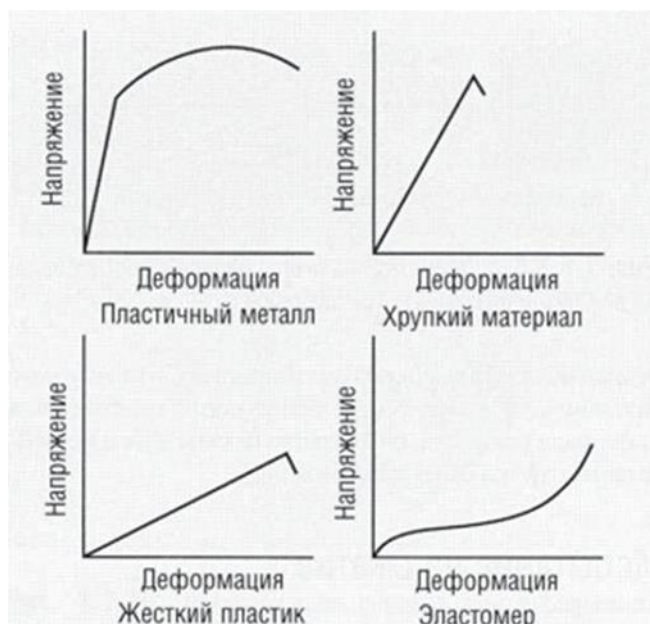
Рис. 1.7.5. Вид кривых напряжение-деформация для материалов различного типа.
