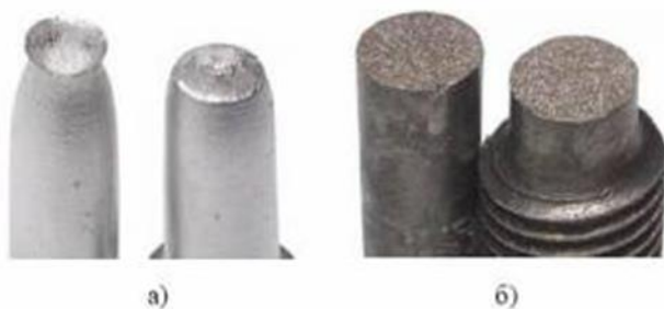
Рис. 1.7. Вид излома на алюминии (а) и хрупкой стали (б)
