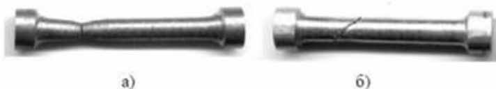
Рис. 1.6. Внешний вид образцов после разрыва: а) пластичный материал (сталь); б) хрупкий материал (чугун)
