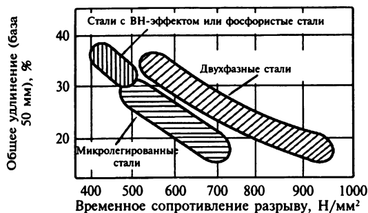
Рис. 5.11. Механические свойства высокопрочного холоднокатаного и отожженного листа толщиной 1 мм
